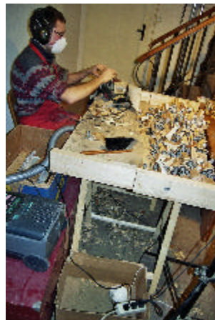
Defekte Bälgechen (davon wurden über 3000 neu beledert) Marcel Masson
