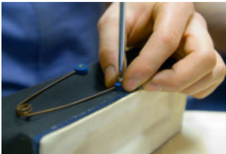
Schenkelfeder für die Einschaltung eines Registers wird befestigt
