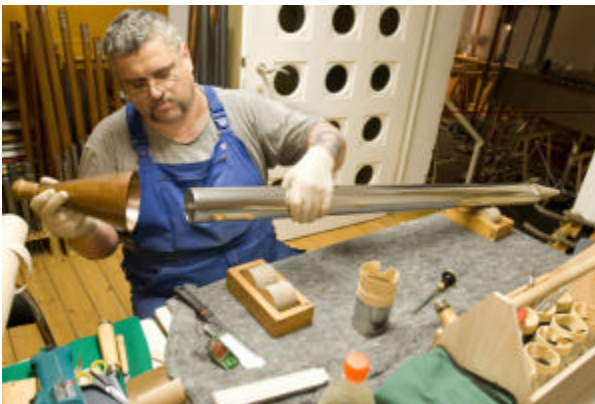
Neue Pfeifen werden auf Tonlänge gekürzt Olaf Mertineit
